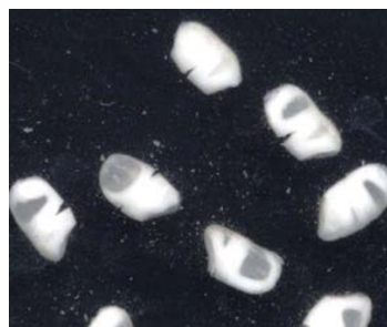
写真 水浸裂傷粒
