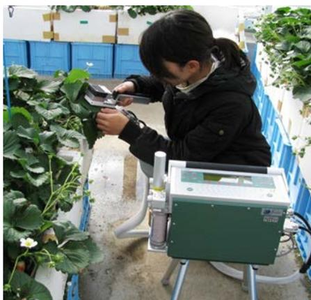
写真 光合成蒸散測定装置を用いた測定の様子
