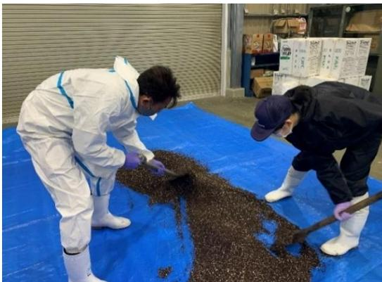
写真1 指定混合肥料の混合作業
