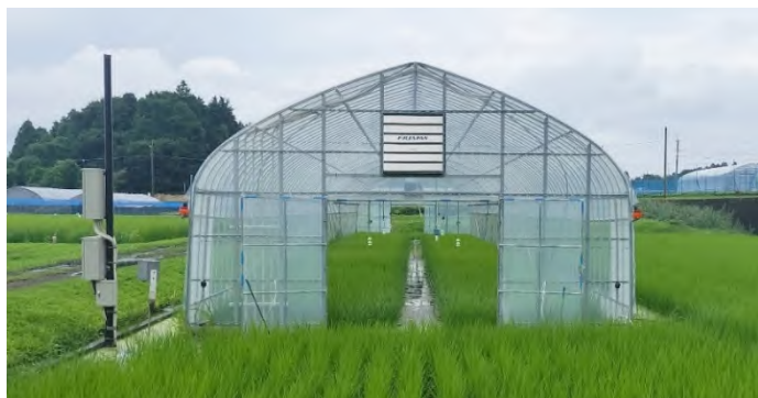
写真1 高温検定ハウス (温度センサー、ファン、自動側窓によりハウス内温度を調節可能)
