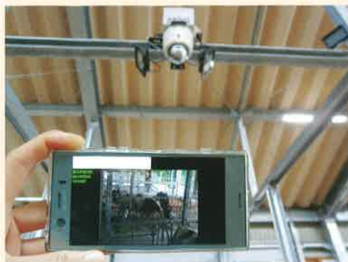
（写真）養牛カメラ スマートフォン等で牛の状態確認や分娩時の進捗状況等が確認できる
