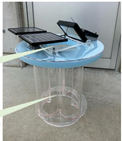
写真1 光集魚トラップ (高さ50cm、直径40cm)
