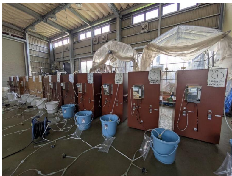
図3：小型堆肥化装置（かぐやひめ）を用いた堆肥化試験の様子
