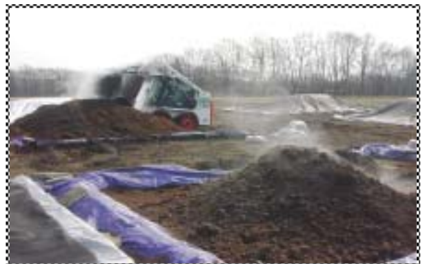
床土を固くすることで重機による切り返し作業が出来る
