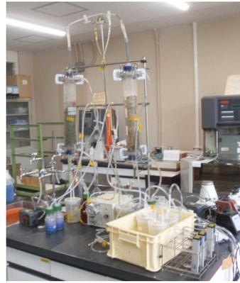
図1 脱臭資材試験装置の概要 (左: 略図、右: 装置写真)
