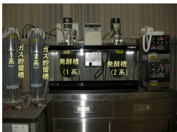
図1 小型メタン発酵試験装置
