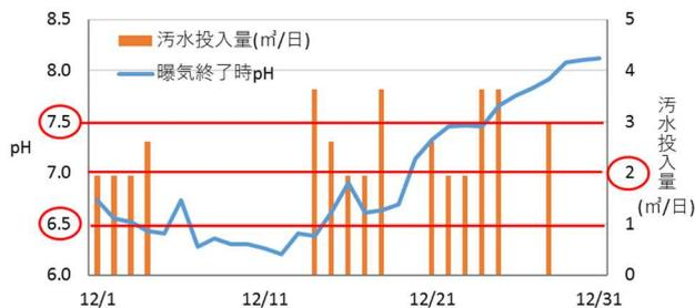
図2 曝気終了時 pH と汚水投入量の推移
