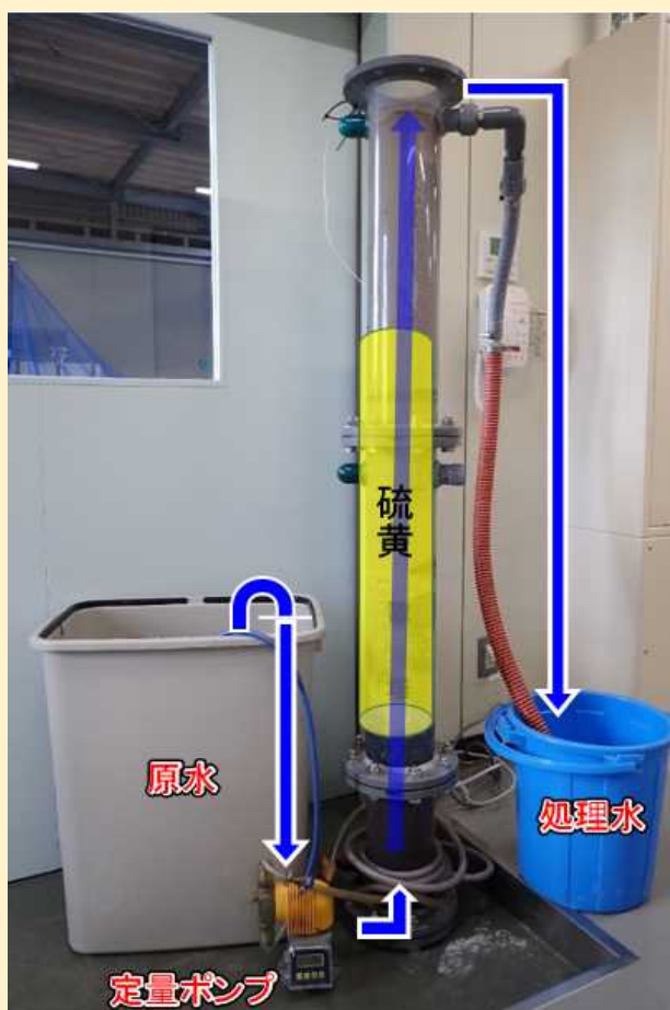
図 上向流試験装置（容積：20ℓ）
