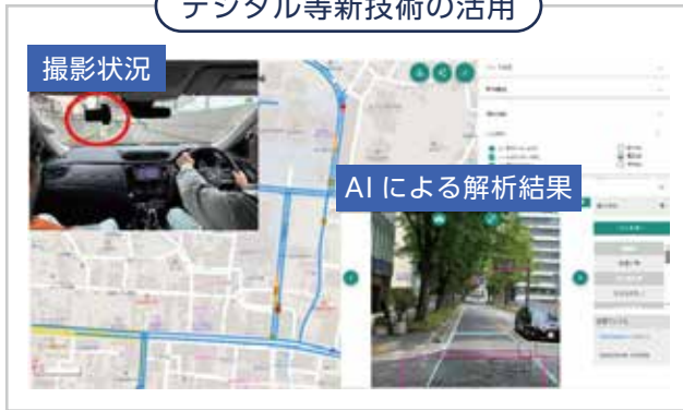
画像診断による舗装点検
