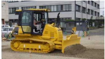
【2015年7月 ICT施工導入 3DMCブルドーザ】
