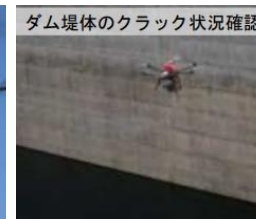
ダム堤体のクラック状況確認
