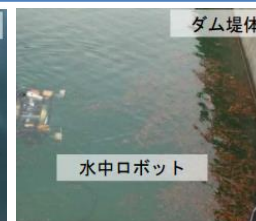
ダム堤体のクラック状況確認
