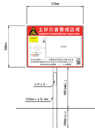
土砂災害警戒区域標識
