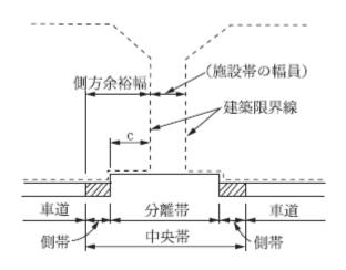
図 3-1 中央帯幅員と側方余裕幅および施設帯幅員の関係
