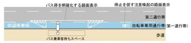
自転車専用通行帯にバス停留所を設置するイメージ (バス交通が多くない場合) =バスベイ型
