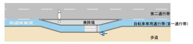
自転車専用通行帯にバス停留所を設置するイメージ (バス交通が多く、道路空間に余裕のある場合) =ストレート型(島型)
