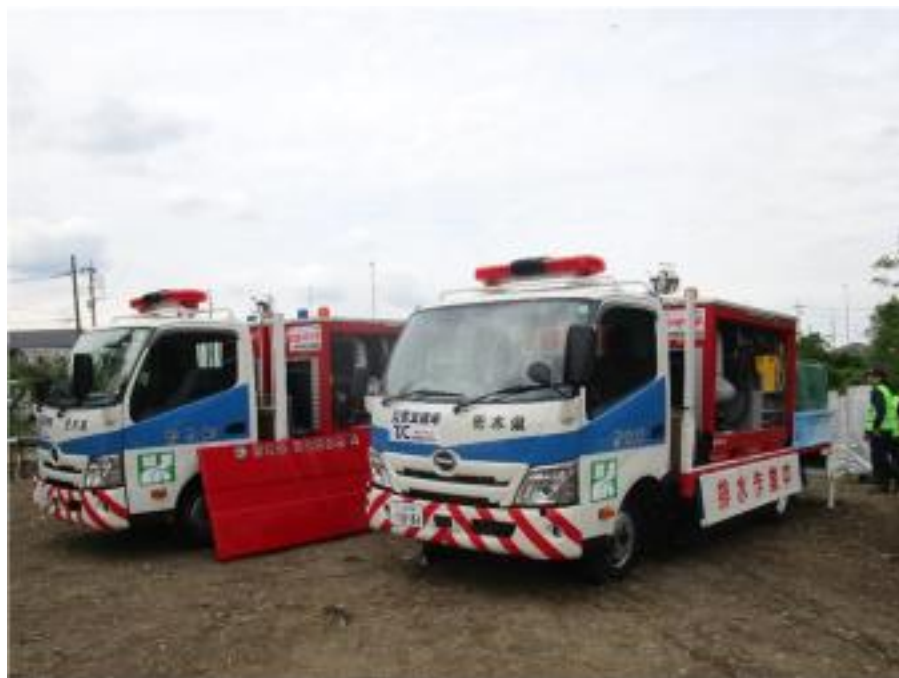
【排水ポンプ車全景】
