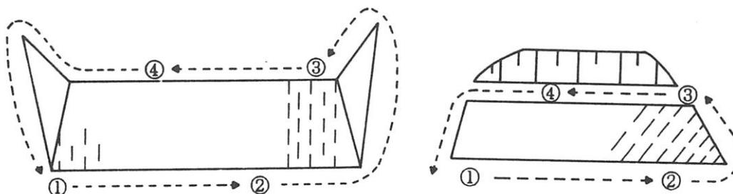
図 2-1 擁壁の被害状況調査経路
