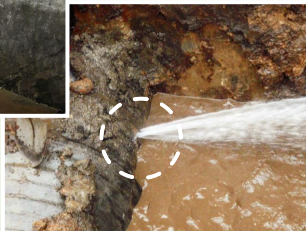
土壌腐食による配水管からの漏水▶
