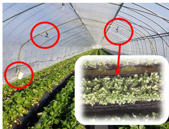
植物体のデータ収集のための定点カメラ
