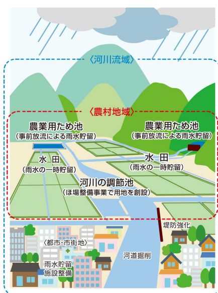
図8 農村地域における雨水流出抑制対策
